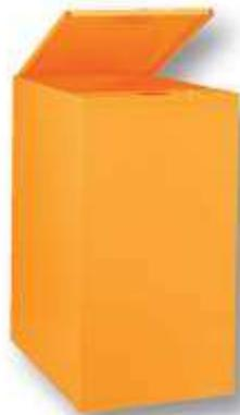
Для горелок SUN P предлагаются емкости для гранул. Емкости выполнены из листовой жести и окрашены в тот же цвет что и котлы SFL. Емкости поставляются в разобранном виде и монтируются с помощью комплекта болтов и гаек. Благодаря обратной верхней пластине бака можно устанавливать шнек, как с левой стороны бака, так и с правой.
