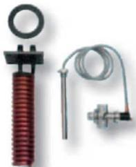
Установка данного комплекта является обязательной согласно директиве EN 303-5. Комплект состоит из клапана безопасности и спирального теплообменника устанавливаемого в тело котла. Теплообменники предлагаются разных размеров и подбираются исходя из номинальной мощности котла SFL. Датчик клапана погружается в теплоприемную гильзу котла и в случае повышения температуры котла свыше 95°C пропускает холодную воду системы водоснабжения через спиральный теплообменник, аварийно охлаждая котел.
